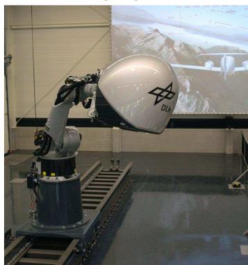
**Abbildung 10.2:** Bewegungssimulator: Roboter auf Linearachse. Der Roboter bewegt die Kanzel, in der sich der Pilot befinden kann, Quelle: [www.dlr.de](http://www.dlr.de), Lizenz: CC BY 3.0.
