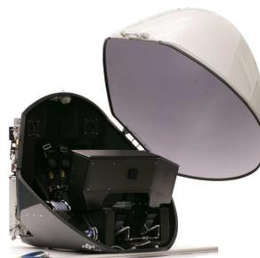
**Abbildung 10.3:** Bewegungssimulator: Roboterkanzel mit Pilotenarbeitsplatz. Die Bewegungsvorgabe wird in der gezeigten Variante durch einen Steuerknüppel eingegeben, Quelle: [www.dlr.de](http://www.dlr.de), Lizenz: CC BY 3.0.
